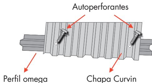
Importante: Antes de la instalación de la cobertura de chapa, debe **retirarse íntegramente el film de polietileno protector** que recubre las chapas prepintadas del techo Curvin, a fin de **evitar adherencias** a la superficie por acción de los rayos solares. **Caso contrario los daños serán irreversibles**
