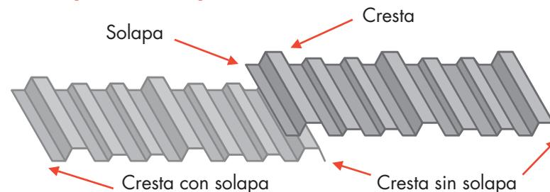
Importante: El solapado debe hacerse montando el lado con solapa por encima del lado sin solapa
