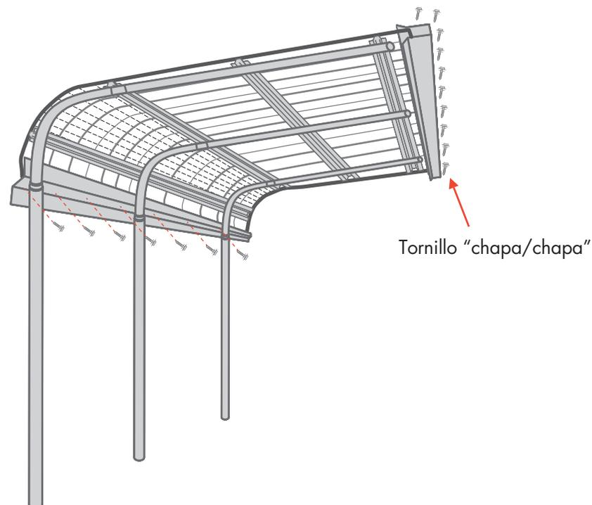
El goterón se fija a la cubierta de chapa Curvin desde arriba colocando, los tornillos autoperforantes "chapa/chapa"
