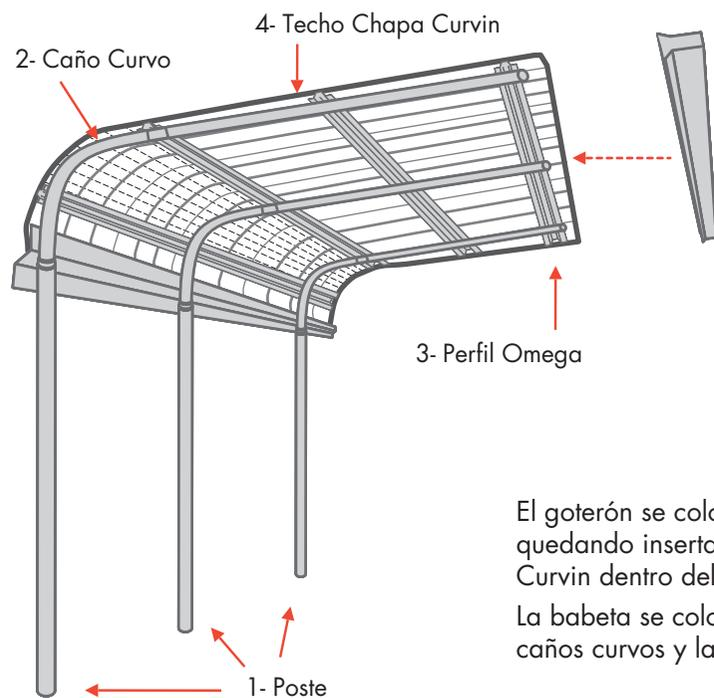
El goterón se coloca en dos tramos, de frente, quedando insertada la cubierta de chapa Curvin dentro del mismo.
