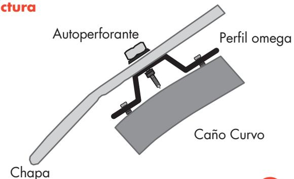
Se debe tener en cuenta que del lado izquierdo, lugar donde la solapa, se comparte la fijación, por eso deben solaparse las chapas y luego colocar los autoperforantes.
